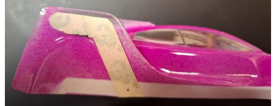
Verstärkung (zum Zeigen außen aufgelegt)
